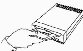
Legen Sie die Disketten mit dem Diskettenaufkleber nach oben (Metallverschluß nach vorne) in das Laufwerk ein. Zum Herausnehmen einer Diskette müssen Sie lediglich die Taste auf der unteren rechten Seite des Laufwerks drücken. Bitte achten Sie darauf, daß die Diskettenlaufwerksanzeige erloschen ist, bevor Sie die Diskette entnehmen.
