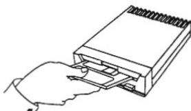
Los diskettes se deben meter en la unidad de diskette con la tapa metálica indicando hacia la unidad y con la parte de la etiqueta indicando hacia arriba. Para sacar el diskette se debe pulsar el botón situado en la parte derecha inferior de la unidad. Siempre esperar que se apague la luz del piloto de la unidad antes de sacar el diskette.
