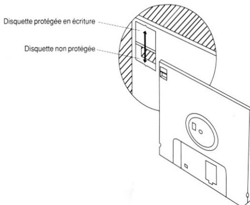
Lorsque la languette est placée vers le haut, vous pouvez voir au travers de la fente. La disquette est alors protégée en écriture, et aucune donnée ne peut y être inscrite. Afin d'être en mesure de sauvegarder, ou d'effacer des données, il faut glisser la languette vers le bas, afin qu'elle recouvre la fente. En cette position, nous disons que la disquette *n'est pas protégée*.
