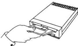
Inserire il disco con l'etichetta rivolta verso l'alto ed il corsoio metallico rivolto verso l'unità. Per estrarre il disco, premere il pulsante posto sul lato inferiore destro dell'unità. Prima di estrarre il disco attendere lo spegnimento della spia luminosa posta sull'unità.
