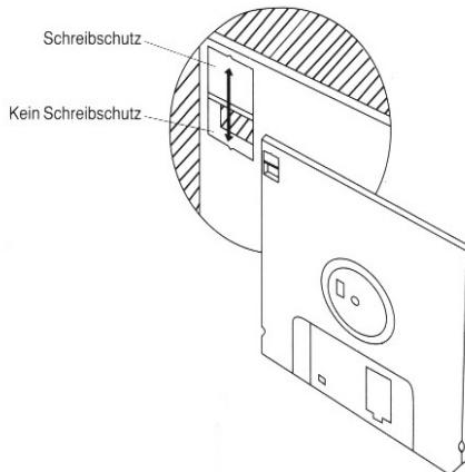
Befindet sich der Schieber in der oberen Position (Öffnung sichtbar), können die Daten auf der Diskette nicht geändert werden. Stellen Sie sicher, daß sich der Schieber in der unteren Position befindet (Öffnung verdeckt). In dieser Stellung ist der *Schreibschutz aufgehoben*.
